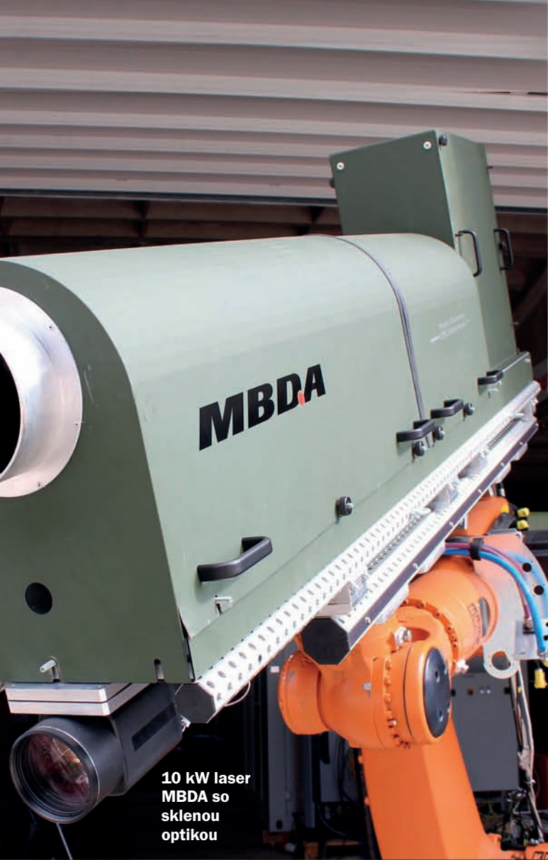
10 kW laser MBDA so zrkadlovou optikou
