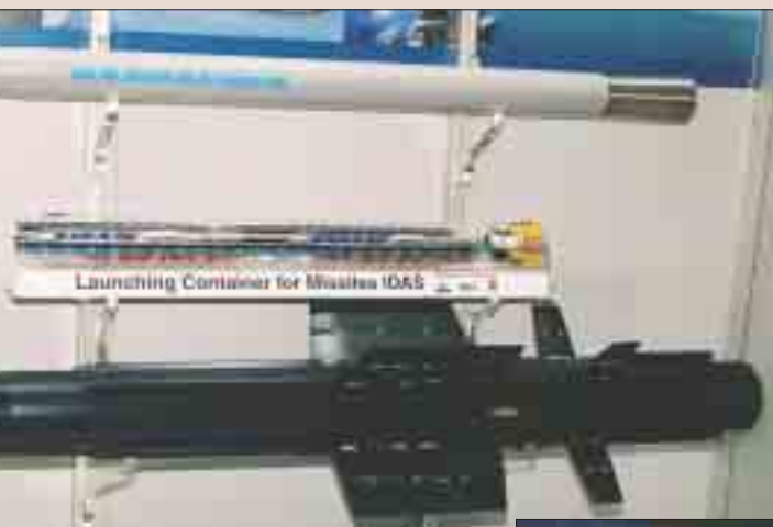
Superkavitačné raketové torpédo Barracuda (hore) a riadená strela IDAS (dole) pre seao-branu ponoriek. Medzi nimi je kontajner pre rakety IDAS
