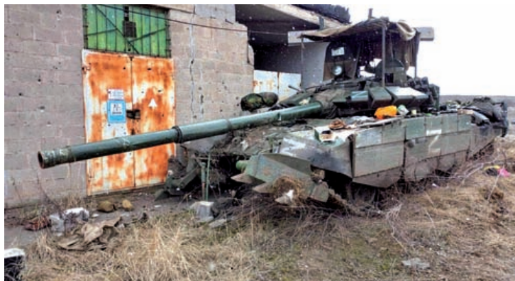
Zničený T-72B3M s improvizovanou ochrannou kľetkou
