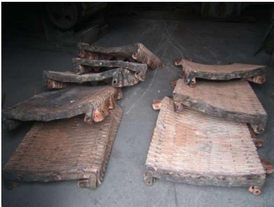
Demontované segmenty roštu z kotla K3
